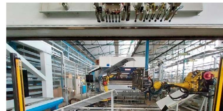
Si è inoltre intervenuti anche sui macchinari per la piegatura delle lamiere optando per presse di piegatura a funzionamento elettrico utilizzate sia dagli operatori, sia dai robot. Anche qui sono state valutate tutte le aspettative che l'investimento doveva soddisfare ovvero:
