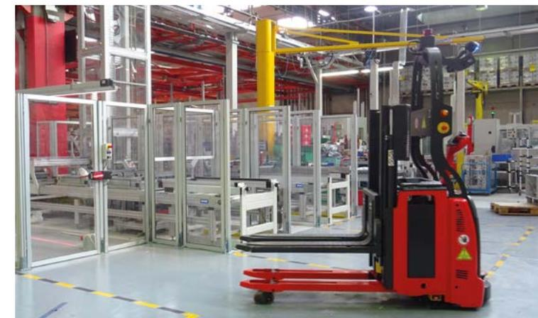
Nelle *Fabbriche Lighthouse* c'è, ad esempio, grande attenzione nei confronti dell'intralogistica: sono operativi numerosi sistemi per la movimentazione automatica dei flussi, come quelli a banda magnetica, a guida laser e, più di recente, quelli a guida autonoma.
